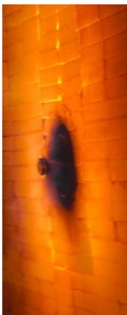
Акустические плоскопламенные инжекционные газовые горелки вихревого типа, с локализацией зоны горения на огнеупорной поверхности кладки печи. Обладают высокой теплопроизводительностью. Обеспечивают полное сгорание газообразного топлива широкого фракционного состава в разомкнутом плоском факеле.
